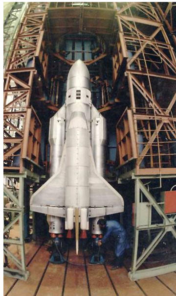
Динамические испытания модели МТКС «Энергия-Буран» 1:10
