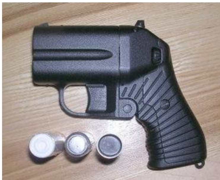
Рис. 2 Фото пистолета ПБ4-СП и патронов для него, слева направо: сигнальный, светозвуковой, травматический.
